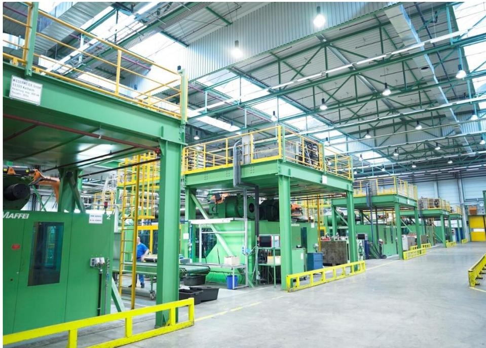
Kunststoffspritzgussanlagen mit Entnahmeroboter
